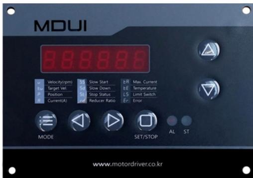
상위제어기와 통신으로 연결되어 이동로봇 구동모듈의 제어 및 모니터링과 이동로봇 파라미터 셋팅 및 전원을 관리합니다.
